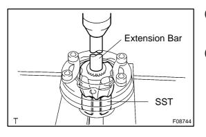
4. REMOVE INBOARD JOINT
