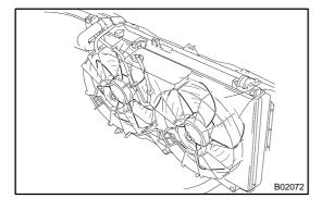
(d) Check that the cooling fan rotates.
