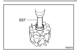
(d) Using SST and a press, press in a new bearing. SST 09820-00031
