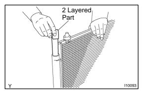
(d) Insert a new dryer into the modulator.
