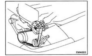
(d) Remove the PS pump pulley nut.
